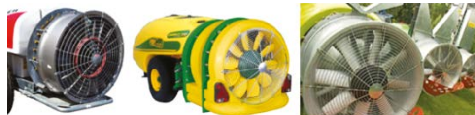
Опрыскиватели с одним, двумя и тремя вентиляторами (Источник: Croplands, Projet and Munckhof, слева направо)
