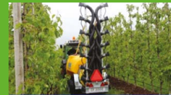
Мачтовый опрыскиватель с поперечным потоком (серия H.S.S. CF2000)
