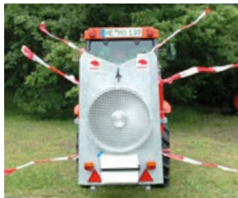
Использование лент для проверки воздушного потока
