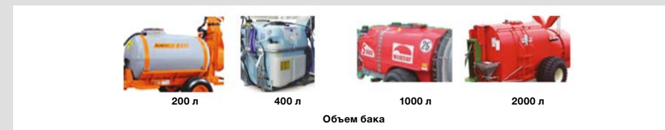
Примеры баков для рабочей жидкости емкостью от 200 до 2000 литров (Источник: Jac to, Carrarospray, Wanner and Rears, слева направо)
