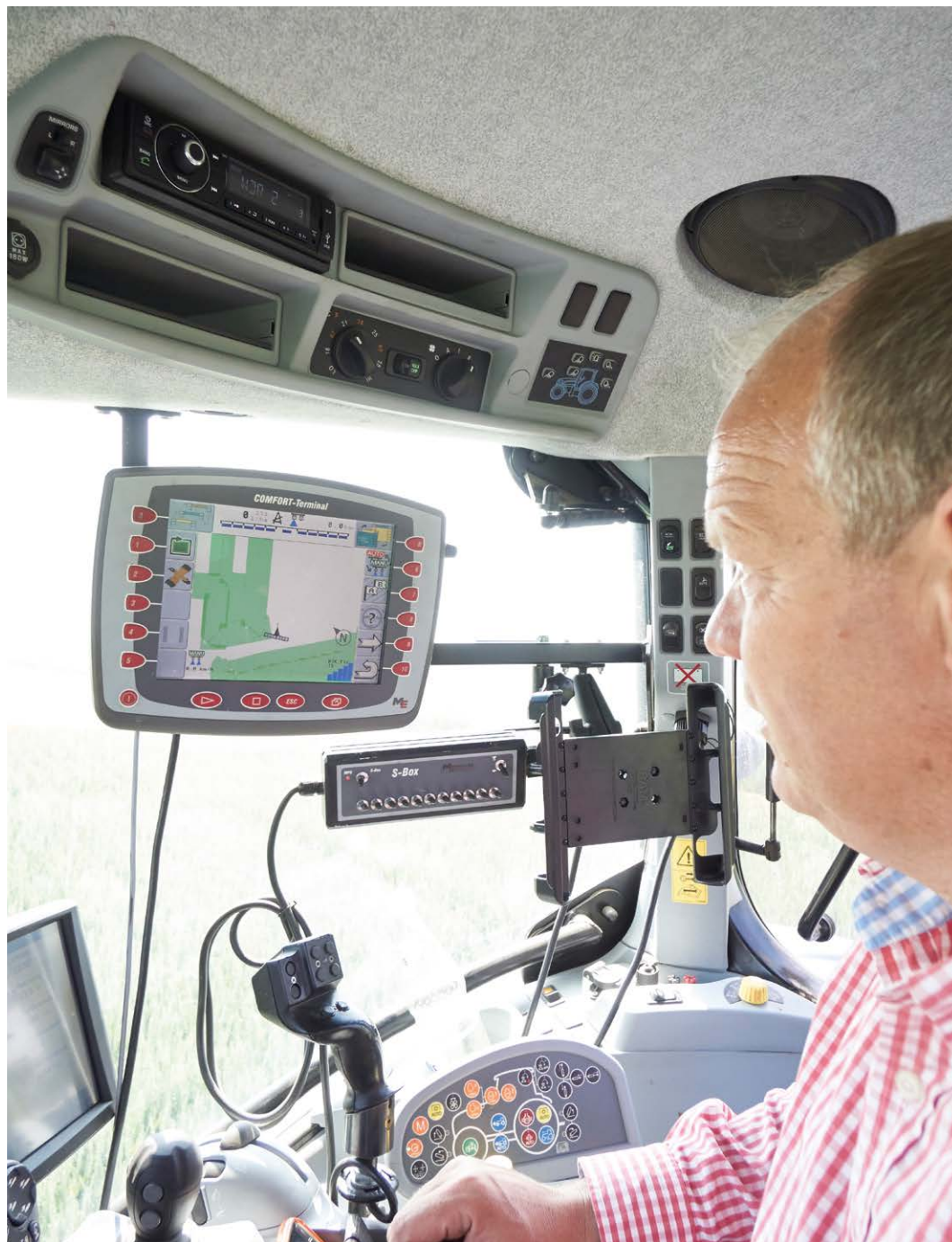
Использование бортовых компьютерных технологий для точного опрыскивания
