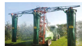
Трехрядный вертикальный опрыскиватель с воздушными рукавами (Источник: Munckhoff)
