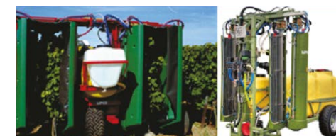
Туннельный опрыскиватель (Источник: Lirco)
