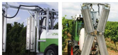
Пример опрыскивателей с диаметрными вентиляторами (с поперечным потоком) (Источник: Weber)
