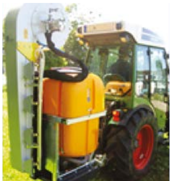
Навесной вентиляторный опрыскиватель (Источник: KMS Rinklin)
