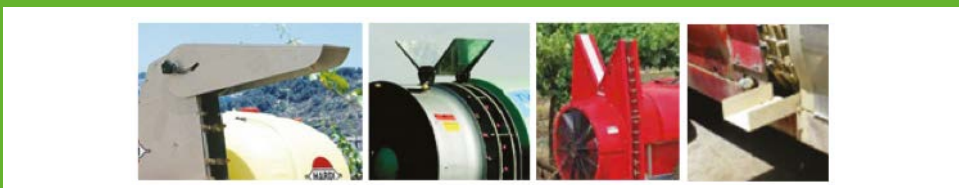
Примеры верхних, боковых и нижних дефлекторов (Источник: опрыскиватели Hardi, Montana и Sylvan, слева направо)
