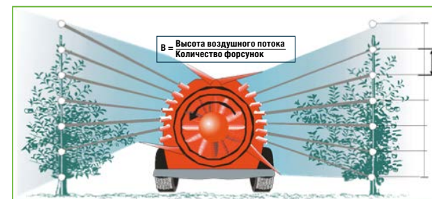
Регулировка воздушного потока опрыскивателя с осевым вентилятором
