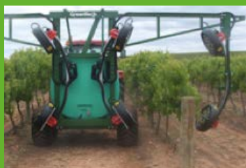
Опрыскиватель с несколькими вентиляторами для опрыскивания 2 рядов (Источник: Croplands и GreenTech, слева направо)
