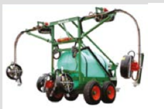
Типы мачт для многорядного опрыскивания (Источник: Jacto), мини-мачты и мачты с низким сносом (Источник: GreenTech)
