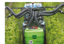
Примеры опрыскивателей с воздуховодами (Источник: C.I.M.A., Nobili and Tecnomat, слева направо)
